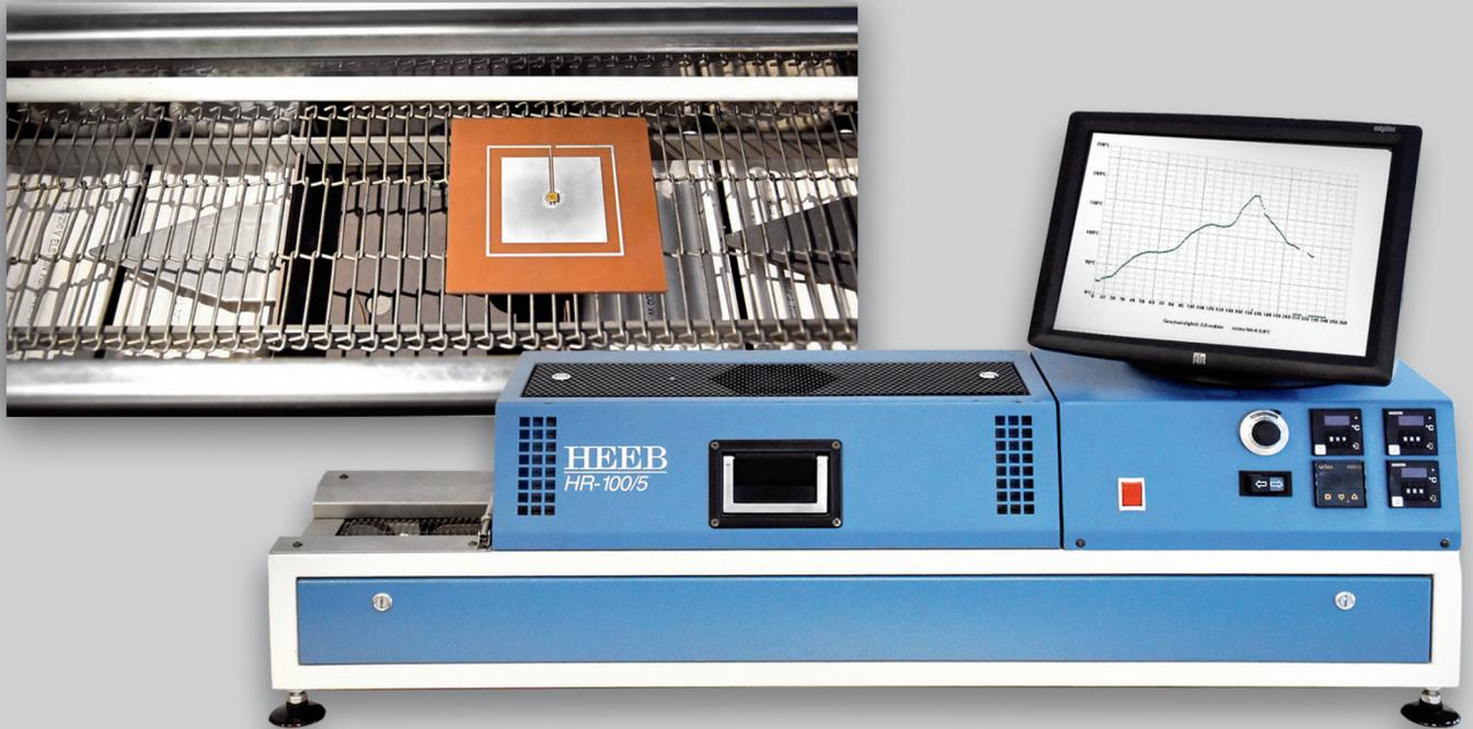
Die Sensorbaugruppe, bestehend aus einem SAW-Sensor und einer entsprechenden Antenne, wird durch einen hochfrequenten Impuls angeregt. Das Antwortsignal, als Maß für die Temperatur, wird mittels einer Auswerteelektronik und entsprechender Kennlinie zu einem Temperaturwert umgerechnet. Hierbei können bis zu 4 Sensoren gleichzeitig abgefragt werden.
