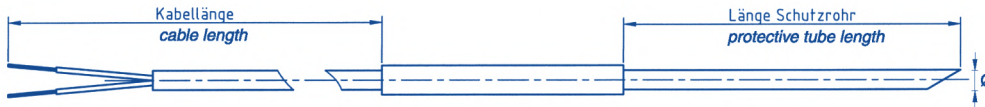
Einstechfühler mit Edelstahlgriff, z. B. Pt 100 \Omega , Pt 1000 \Omega , NTC Penetration probe with stainless steel handle, e.g. Pt 100 \Omega , Pt 1000 \Omega , NTC
