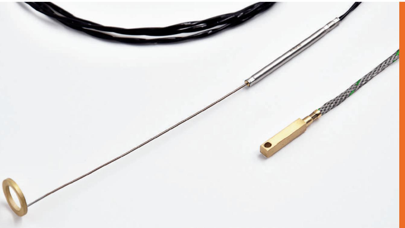
Die Oberflächenfühler sind für die Messung von Oberflächentemperaturen angepasste Thermoelemente. Die Schutzhülsen besitzen eine große Oberfläche um eine gute Wärmeübertragung zu gewährleisten, durch vorhandene Bohrungen können sie dauerhaft auf die Oberfläche geschraubt werden. Auch gefederte Messspitzen sind möglich.
