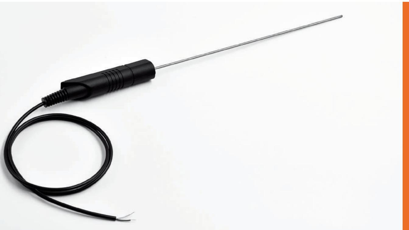
Die Fühler sind mit den Paarungen NiCr-Ni (K), Fe-CuNi (J) nach IEC 60584-1 bzw. Fe-CuNi (L) nach DIN 43710 (zurückgezogen) erhältlich. Der angegebene Einsatztemperaturbereich bezieht sich auf den sensitiven Teil an der Messspitze. Für die max. zulässige Temperatur am Griff und der Anschlussleitung gelten die werkstoffabhängigen Kennwerte.
