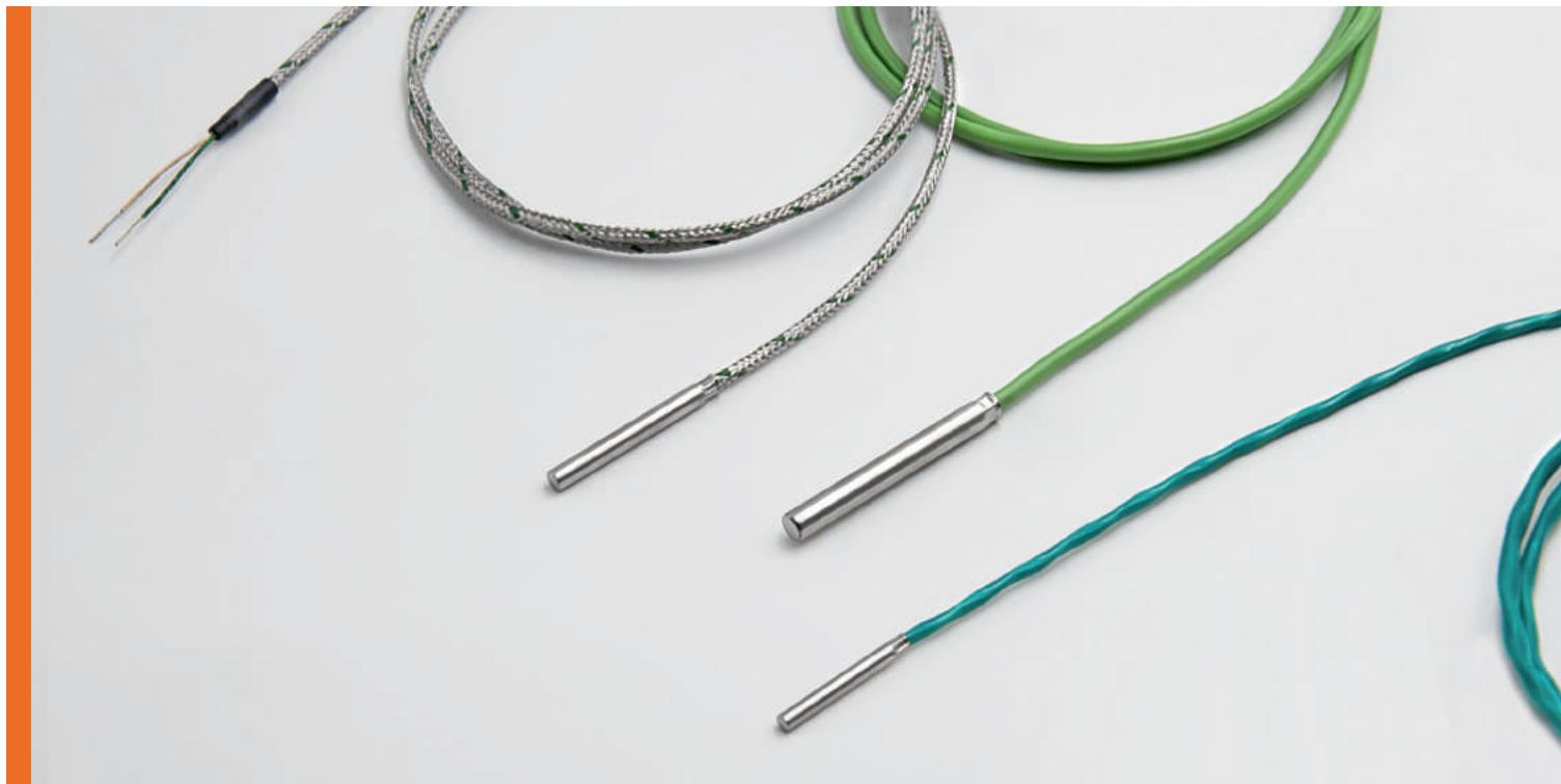
Diese Fühler ermöglichen die Erfassung von Temperaturen in flüssigen und gasförmigen Medien. Bei Hülsenthermoelementen bietet die Tauchhülse einen mechanischen und chemischen Schutz des Thermoelementes. Reine Kabelthermoelemente mit freiliegender Schweißperle sind empfindlicher, besitzen jedoch eine kürzere Ansprechzeit.
