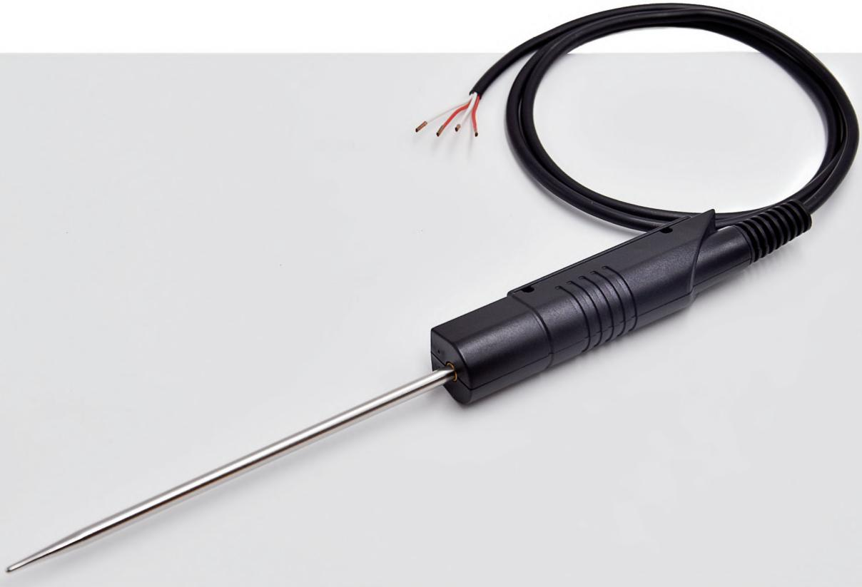
Die Fühler sind nach DIN EN 60751 in Klasse B und Klasse AA (1/3 DIN, bei 0 °C) erhältlich. Der angegebene Temperaturbereich bezieht sich auf den sensitiven Teil in der Messspitze. Für die max. zulässige Temperatur am Griff und der Anschlussleitung gelten die werkstoffabhängigen Kennwerte (PA max. 130 °C).
