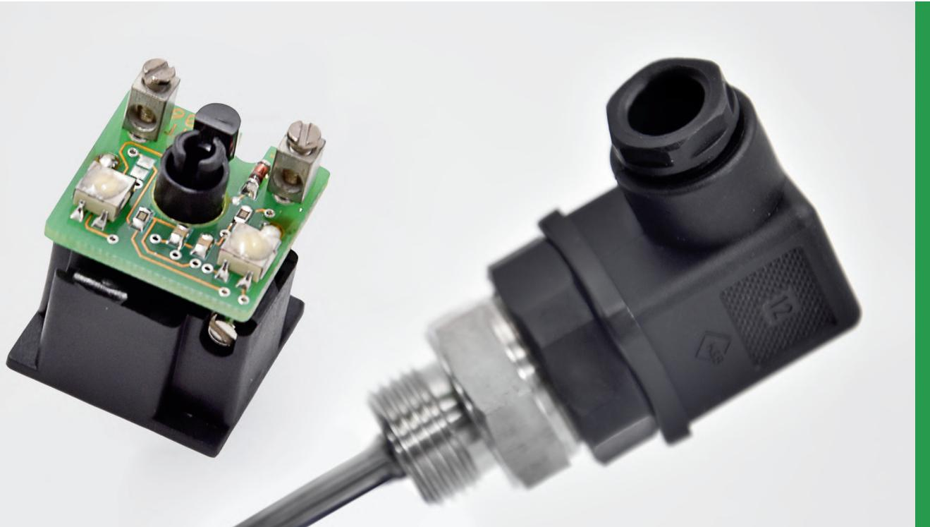
Das Widerstandsthermometer mit dem Messumformer MATPI wandelt den temperaturabhängigen Widerstand eines Platin-Messwiderstandes hochgenau in ein 4 bis 20 mA Standardsignal um. Als Messumformergehäuse wird eine Anschlussdose nach DIN 43650 verwendet. Somit ist die Nachrüstung eines Messumformers, für einen Temperaturfühler mit Steckanschluss nach DIN 43650, durch einfachen Austausch der Anschlussdose möglich.
